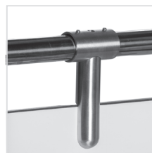
Horný trubkový profil, priemer 30 mm (nerez), do šírky dosky 60 mm nemusí byť horný profil použitý
