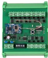
**SLZA 15** **88150** Rozdeľovač ventilov na DIN lištu
